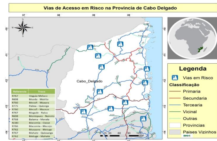
Figura 11: Mapa de estradas em risco de inundação na província de Cabo Delgado
